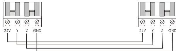
外接多台 KST-POWER8 电源控制器时的接线如下：
